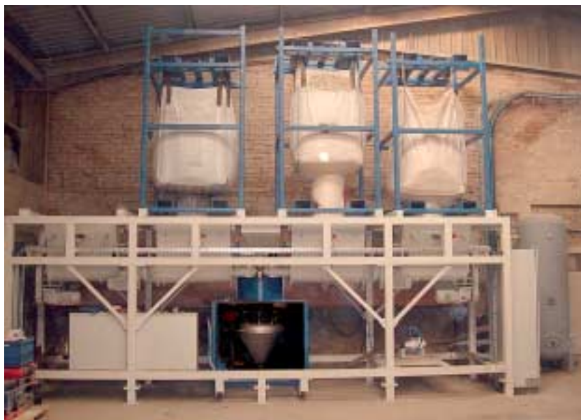
Fig. 2 Four color powder pigment system with pneumatic conveying in two independent mixers. Abb. 2 Vier Farben Pulveranlage mit pneumatischer Förderung in zwei getrennt arbeitende Mischer.
