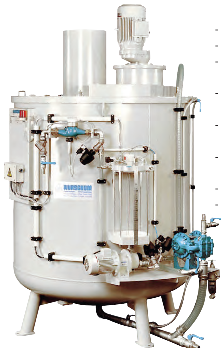
Смеситель MDI 3000 с объемом 3000 л со штуцером для Биг-Бэгов и дозирующим цилиндром для химдобавок
