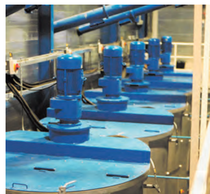
Смеситель MDI 8000 с объемом 8000 л для получения суспензий красителей
