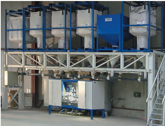
▲ Система дозирования гранулятов COM 70-3 с 3 промежуточными емкостями для 6 цветов в 3 смесителя
