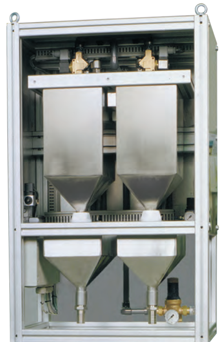
▲ ES 15/15 Весы из нержавеющей стали в защитном шкафу с 2 цилиндрами по 15 л и разгрузкой самотеком
