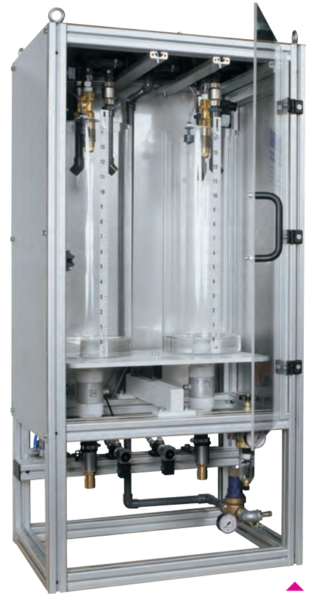
▲ Весы AC 15/15 в защитном шкафу с 2 цилиндрами по 15 л и разгрузкой самотеком
