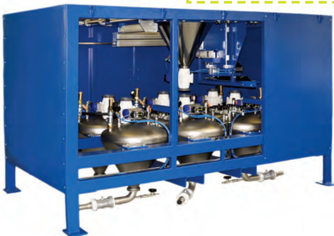
▲ Система дозирования COM 70-6 с 6 промежуточными емкостями для 1 или более смесителей или до 6 порций взвешенного пигмента
