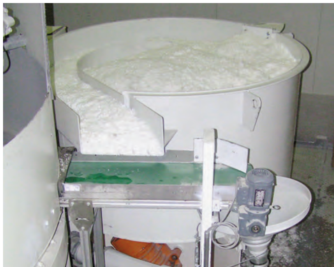
▲ Дозировочная система MD 500 SX для синтетической фибры, производительностью 3-15 кг/мин., загрузочный барабан до 400 кг
