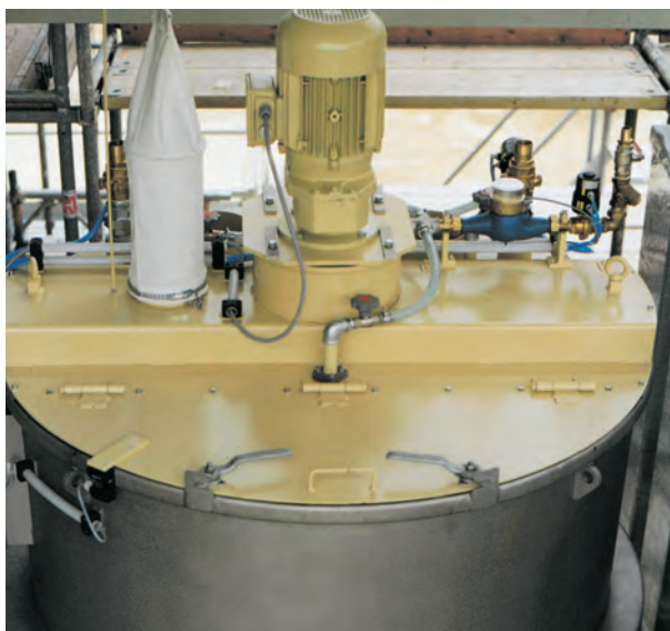
Установка для взвешивания порошковых продуктов и смешивания их с водой, тип АНМ 2020 объемом 2000 л. Емкость подвешена на 3 тензодатчиках, подходит для взвешивания различных компонентов, например, ангидрида, воды и бетонных добавок
