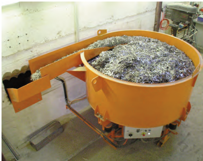
▲ Дозировочная система MD 400 для металлической фибры, производительностью 40-150 кг/мин., загрузочный барабан на 600-1200 кг
