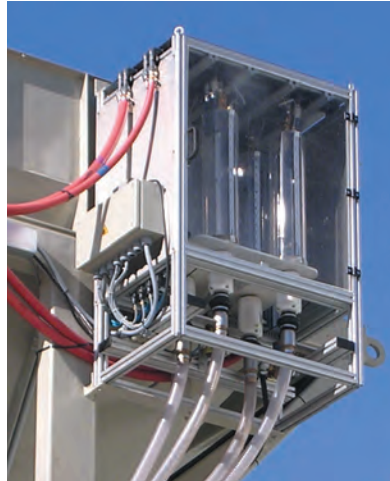
▲ Весы AC 5/5/15/15 в защитном шкафу, разгрузка самотеком, для 8 добавок в 4 цилиндрах
