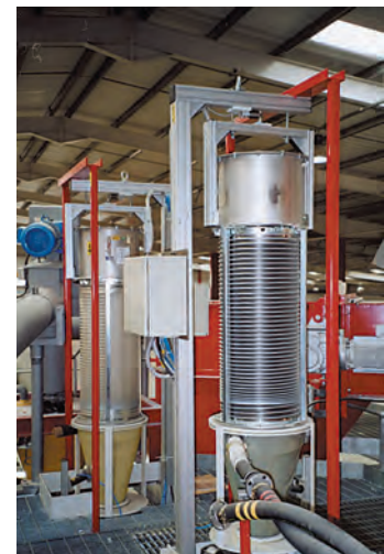
▲ Фильтр-циклон CF 40-S с тензодатчиком и легко очищаемым фильтром
