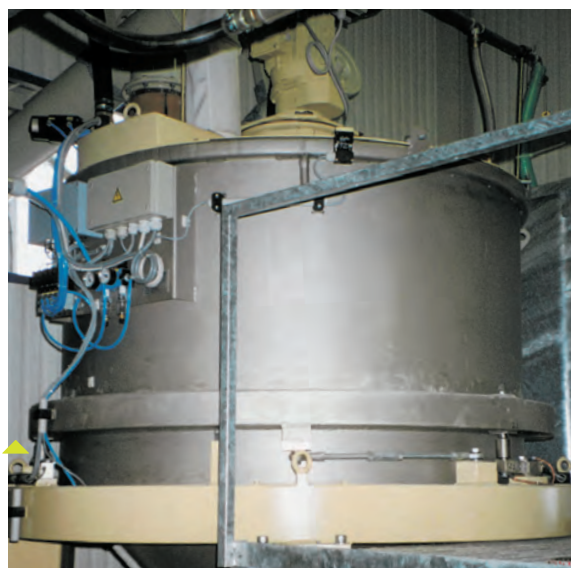
Установка для взвешивания порошковых продуктов и смешивания их с водой, тип АНМ 2020 объемом 2000 л. Емкость подвешена на 3 тензодатчиках, подходит для взвешивания различных компонентов, например, ангидрида, воды и бетонных добавок
