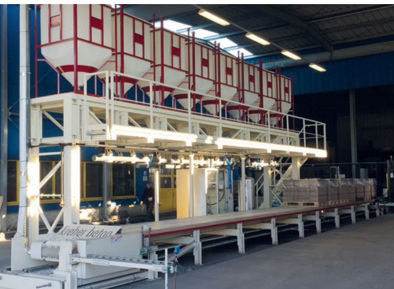
Gesamtanlage mit 8 Farbpositionen in Reihe
