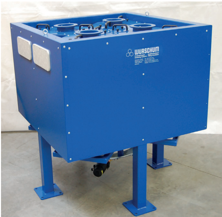
Mini-Com 10-4 с точностью дозирования \pm 1 г
