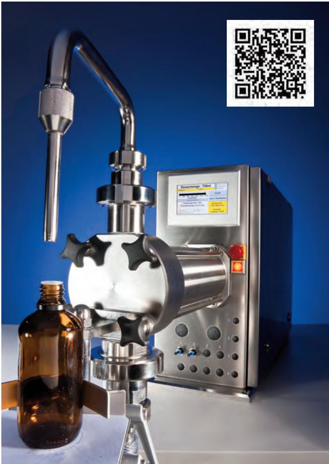
Полуавтоматические наполнители с сервоприводом, выполненные из нержавеющей стали и оборудованные сенсорной панелью управления и памятью для хранения рецептов
